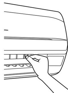
Detenga las aletas horizontales a una posición en la que puede mantenerlas y ajustar las pestañas a izquierda y derecha.
