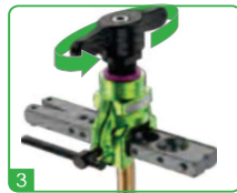
3 Desliza el cuerpo del avellanador al agujero correspondiente
