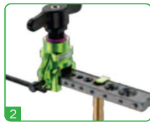
2 La tubería de cobre se inserta en el agujero, y se ajusta con el tope lateral
