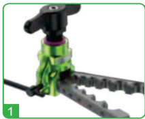
1 El prensa tubo se introduce en el cuerpo del avellanador
