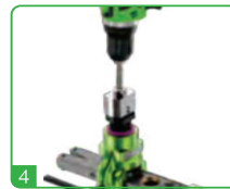
4 Utiliza un taladro inalámbrico para un avellanado rápido
