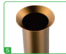
5 Completa el avellanado a 45° de la tubería de cobre
