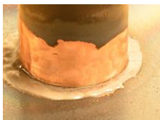
Aspecto del fundente cerca de la temperatura de soldadura.
